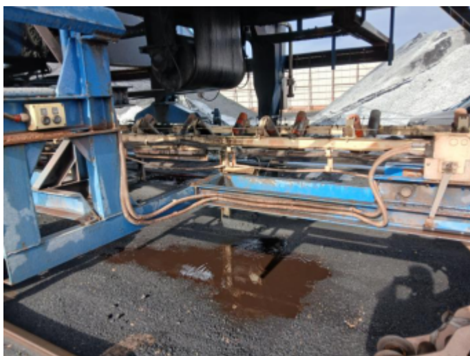
Slika 7 in 8 : krmilna tastatura (S3) in končna stikala na valjčnem vodilu (S1)
