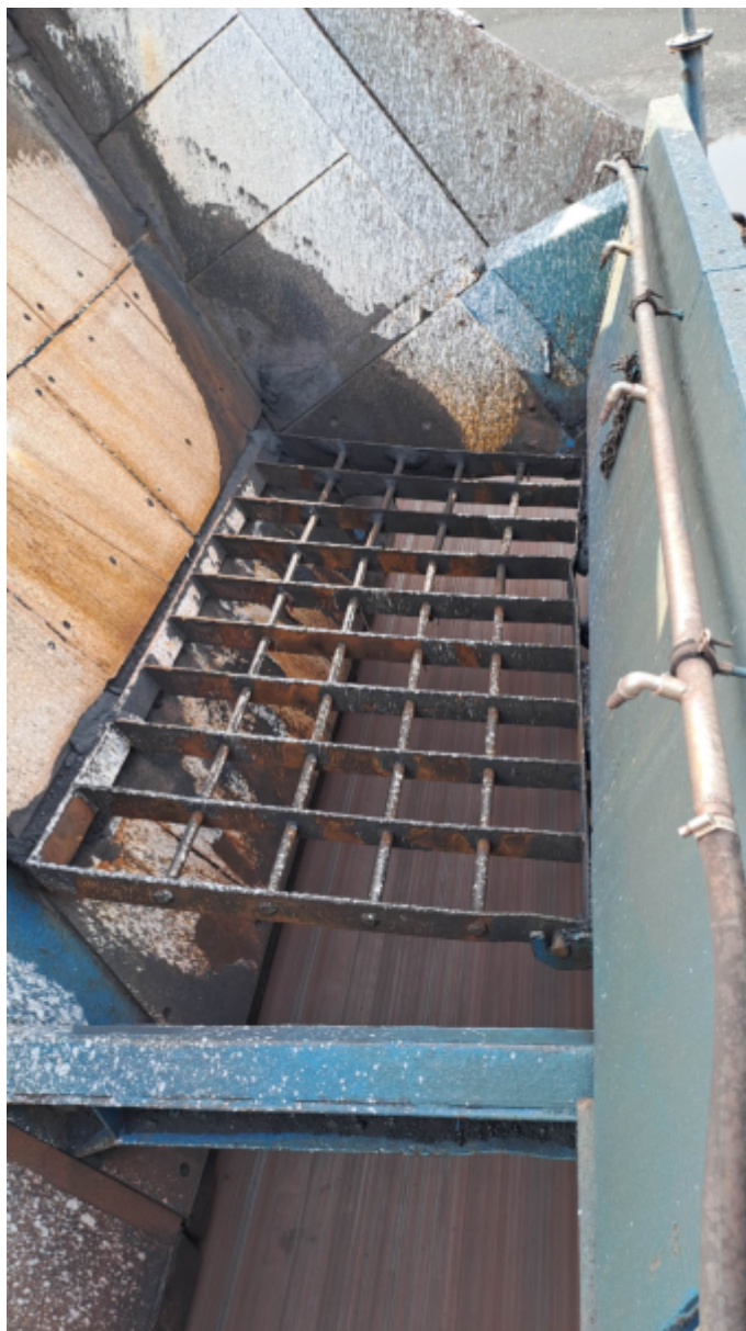
Slika 1.2: Presipni del na koncu odlagalne ročice
