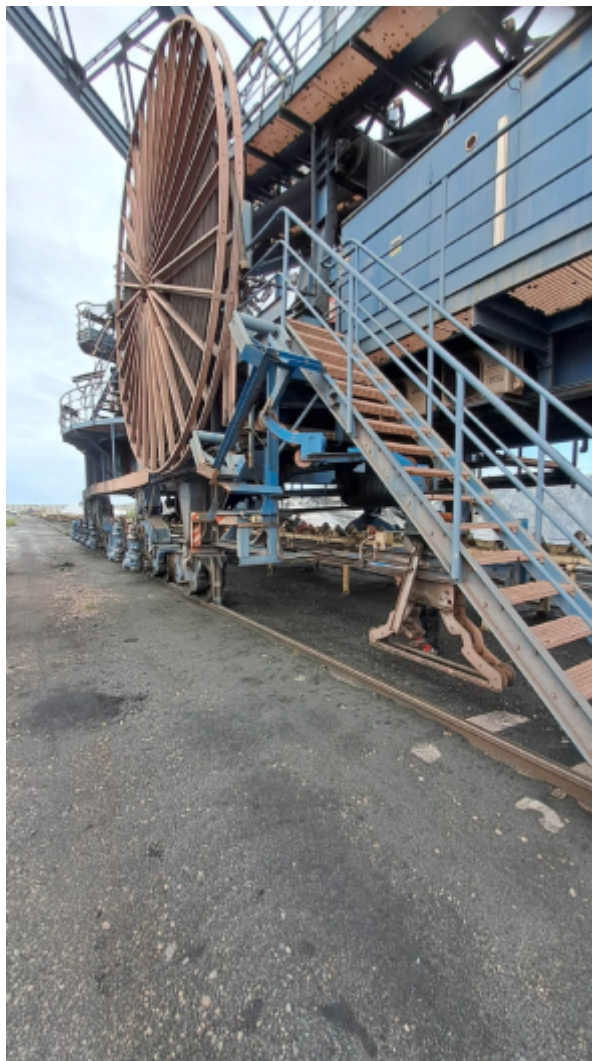
Slika 1.1: Navijalni boben vodne cevi in uvod cevi na boben
