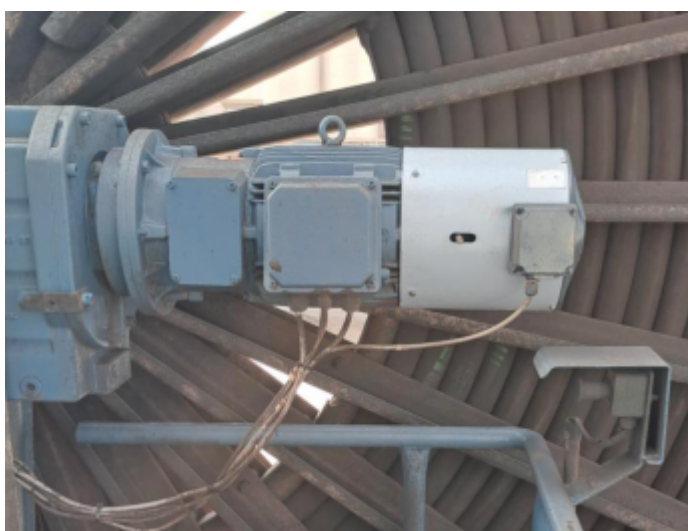
Slika 5: motor navijalca z termistorjem (M1), ventilatorjem (M2) in zavoro (Y1)
