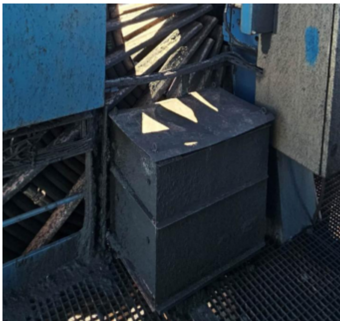
Slika 6: omara z rotorskimi upori (R1)
