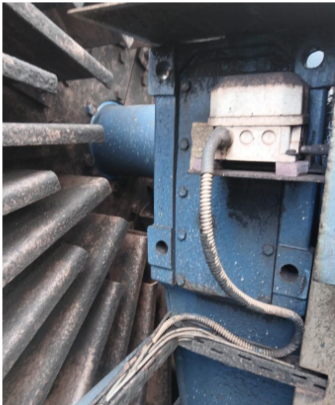
Slika 8 : končna stikala na reduktorju (S2)
